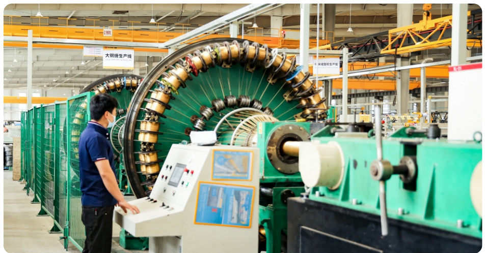
大口径钢丝缠绕生产线 Big Diameter Steel Wire Spiral Production Line
